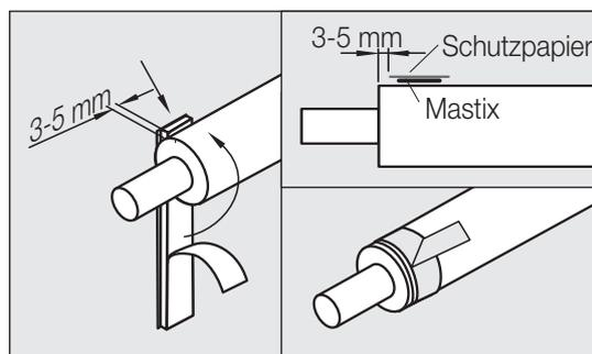
3. Schutzfolie von dem Mastixstreifen entfernen und Haftseite gegen den Mantel ca. 3-5 mm von der Ende des Mantelrohrs anbringen. Eine Schleife mit dem Schutzpapier machen.
