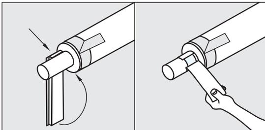
4. Haftseite des Mastixstreifens durch Abziehen des Papiers freilegen und gegen den Stahlrohr so dicht neben der Isolierung wie möglich anbringen. Dem Schutzpapier den Stahlrohr entfernen.
