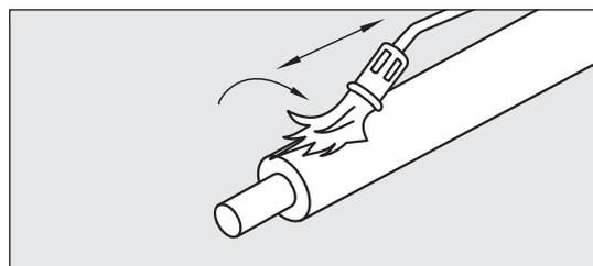
2. Mantel mit dem Gasbrenner mindestens 60 mm von der Rohrende aktivieren, bis die Oberfläche seidig glänzt.
