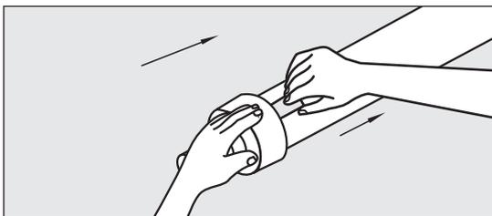
5. Endkappe aus der Verpackung nehmen. Sicherstellen, dass die Endkappe außen und innen SAUBER und TROCKEN ist. Endkappe über den Stahlrohr und den Mastixstreifen führen. Haftseite des Mastixstreifens durch Abziehen des Papiers freilegen und gegen den Stahlrohr so dicht neben der Dämmung wie möglich anbringen.
