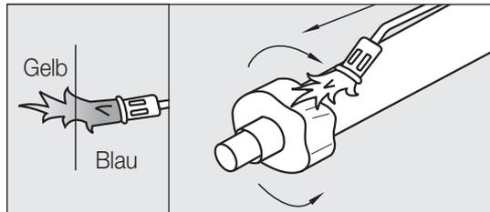
7. Brennerflamme justieren, damit das Gelbe ca. 8-10 cm mißt. Endkappe erst auf den Mantel aufschumpfen. Nie direkt auf der Kante erwärmen, da sich der Mantelwerkstoff hierdurch verfärbt.
