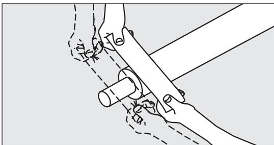
1. Die Rohrende muß SAUBER und TROCKEN sein. Mantelrohr mindestens 60 mm von der Rohrende mit Schmirgelleinen anschleifen.
